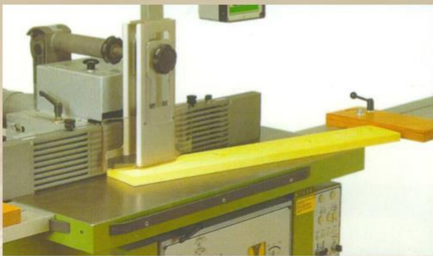
Lielu detaļu frēzēšana, izmantojot atduru
