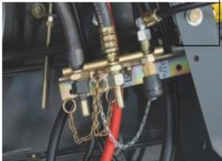
Dzinēja un hidrauliskās eļļas noliešanas ventili, saspiestā gaisa pieslēgums (opcija)
